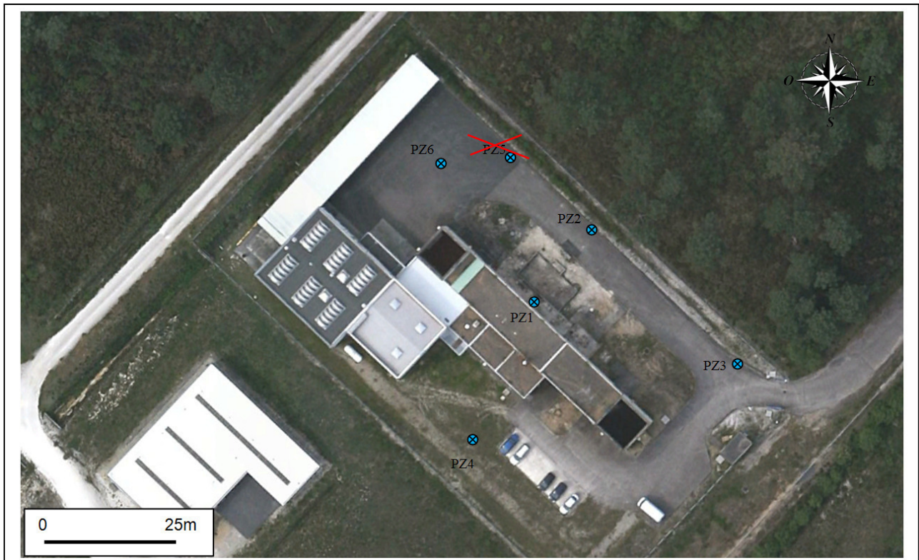
Figure 4 : Carte du réseau piézométrique de surveillance
